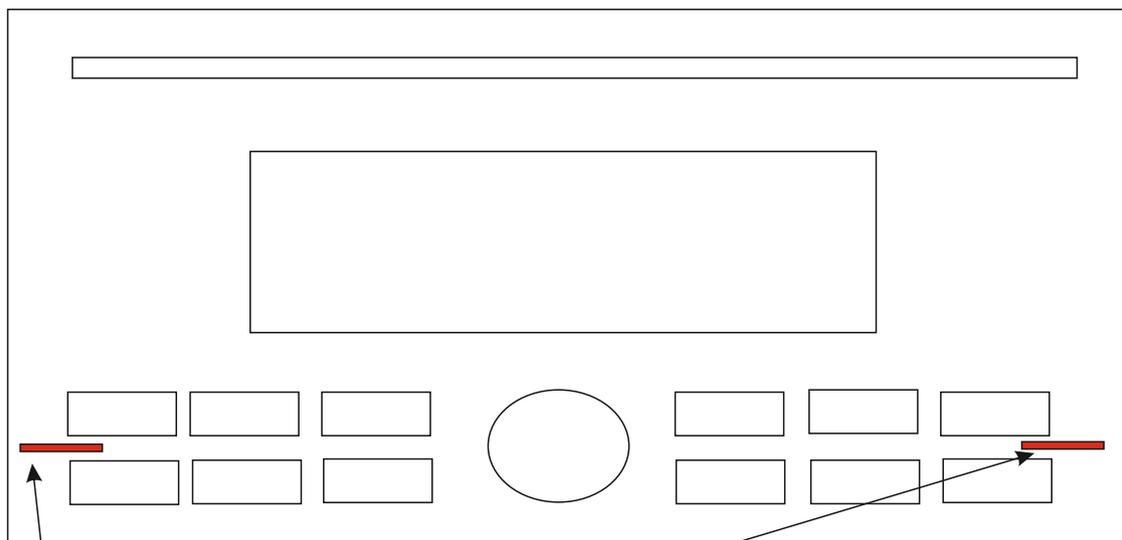
Inserire le 2 chiavette per estrarre la radio dalla sua sede fino a sentire un click di innesto . Dopo ciò tirare fuori la radio per inserire il connettore sulla parte posteriore .
